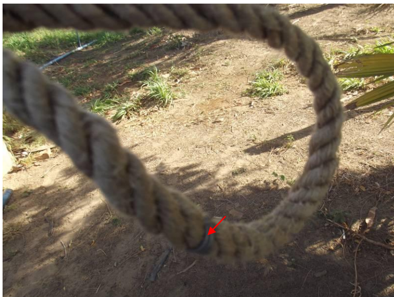
Fig.3 – Medidor de nível improvisado. A seta indica as marcações a cada metro.
