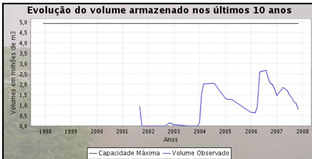
Gráfico 2 – Evolução do volume de água armazenada do açude São Francisco II nos últimos anos
